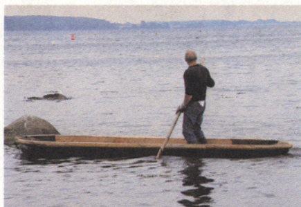
Den første prøvesejlads. Her afgøres det, om der skal hugges mere af bund eller sidekanter for at få bedre balance.
