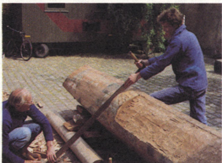
Der saves for inden kilningen, her med henblik på bådens ydre form. Selve kileteknikken fremgår af skitsen næste side.
