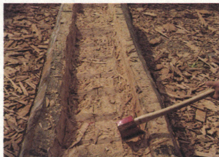
Udhulingen er påbegyndt. Der hugges stoprender inden udkilingen.
